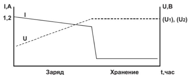
**Рис. 4 График работы ЗУ Вымпел-07**
