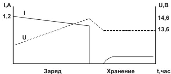
**Рис. 3 График работы ЗУ Вымпел-05**
